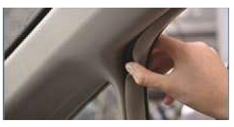
4. При установке под уплотнителями рамы двери автомобиля отогните уплотнитель.
