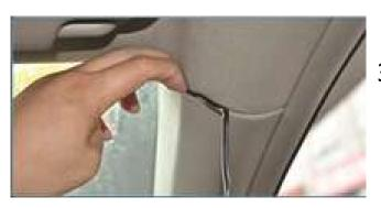
3. Спрячьте провод питания между швами внутренней обшивки автомобиля.
